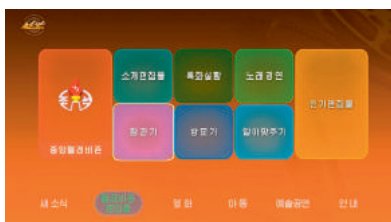
[그림 1] '만방' 단말기 규격 - 운영 체제: Android 4.4 - 프로세서: S805 Cortex A5 쿼드 코어 1.5GHz - 메모리: 1GB DDR3, 8GB 플래시 - 비디오 포맷: H.265, H.264, MPEG1 / 2 / 4, DivX / Xvid, 3GP, m2ts, MKV, MP4 - 오디오 포맷: MP3, AAC, WMA, MID, OGG, WAV - 이미지 형식: JPEG, PNG, BMP, GIF, JPG - USB 포트: USB 2.0 2개 - 이더넷 포트: 10 / 100Mbps - 디지털 비디오 출력: 1,080x720 픽셀의 HDMI 1.4a - 아날로그 비디오 출력: RCA (출처: Martyn Williams(38north.org))
